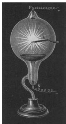
Fig. 172. Katodestråler frembringer Ophedning.
