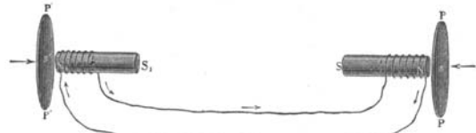
Fig. 192. Principet for Telefonen.
