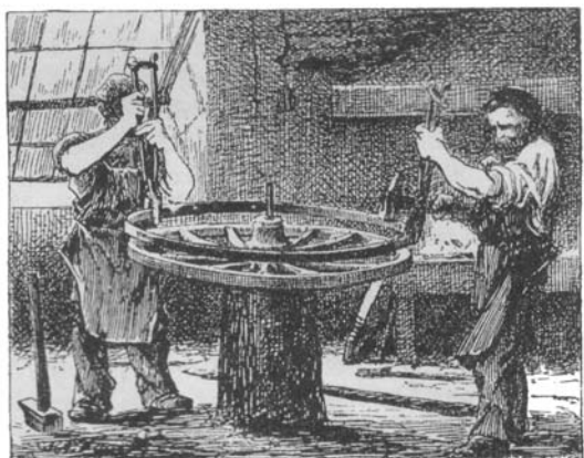
Fig. 464. Smeden lægger Ring om Hjulet.
